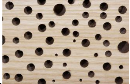
Die Löcher sind sauber gebohrt. Der Abstand könnte teilweise etwas größer sein.
